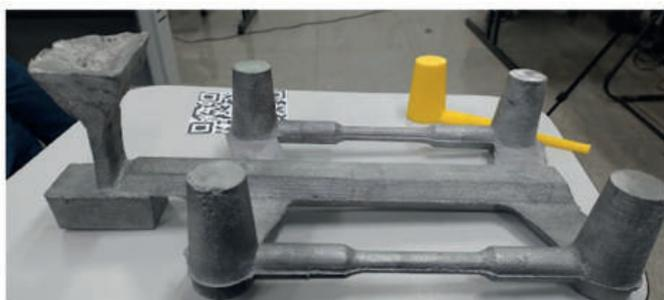
Corpo de prova por fundição em areia
